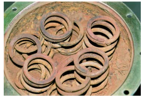
Bild 8: Ausfall eines Stellantriebes durch Korrosion
