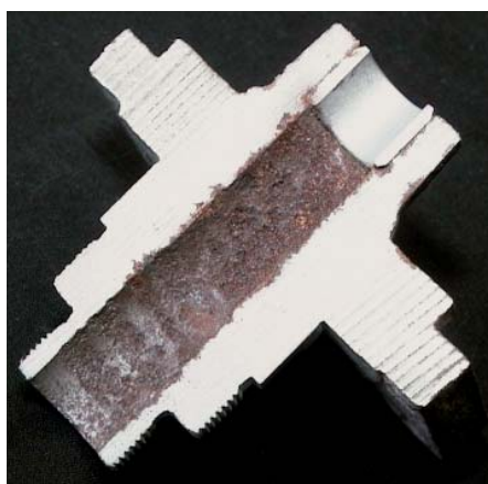
Bild 5: Korrosion des Stopfbuchsraums Fig. 5: Corrosion of the stuffing-box chamber
